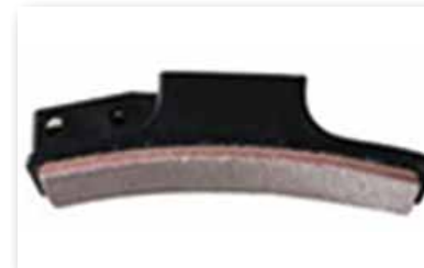
需要维护的刹车片，易磨损，刹车不稳定顿挫感强
